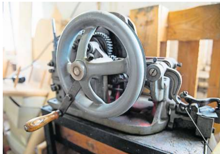
Mit Maschinen wie dieser Handbedienten Doppel-Nähmaschine wurden die Schuhe der Marke Sumag hergestellt.
